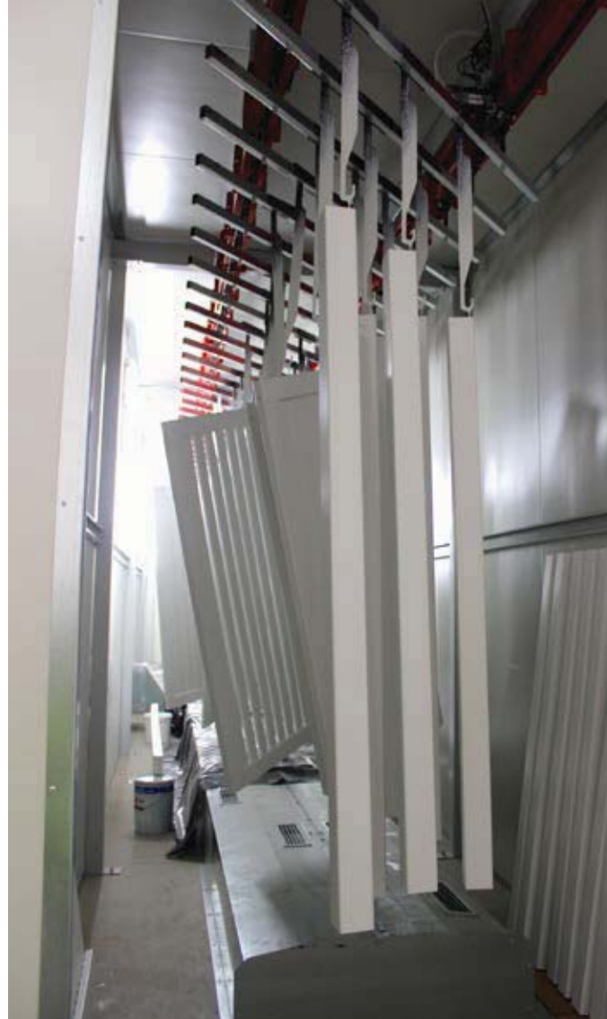
Les produits peints transitent par une chambre de séchage.
