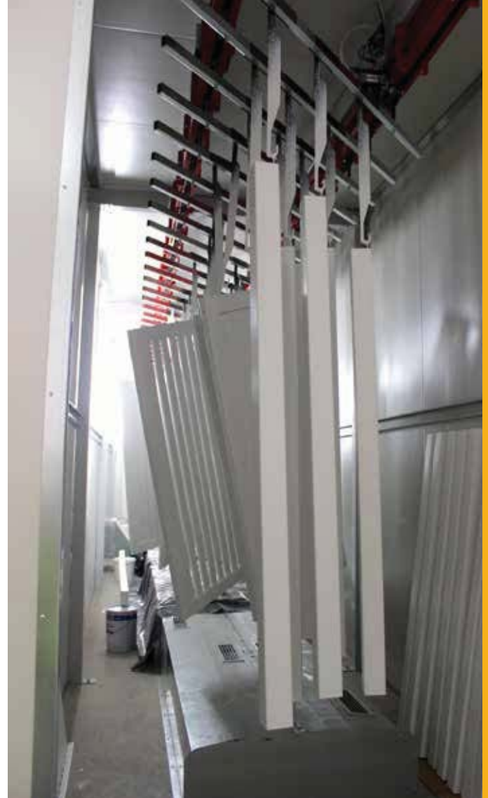
Lackierte Produkte in der Trockenkammer
